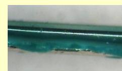
Fig. 3 塗装による絶縁被覆の拡大写真
