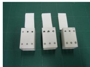
九州セラミックス工業(株)と今年度試作開発した一体構造化セラミックス碍子
