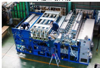
全自動乾海苔製造装置「トライスター」組立風景
