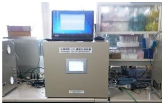
水素燃料CO濃度計測装置
