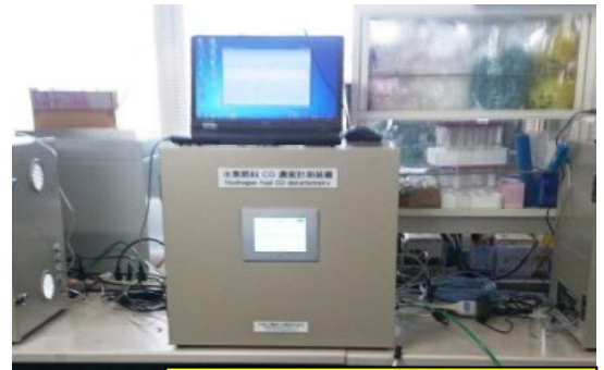
水素燃料CO濃度計測装置
