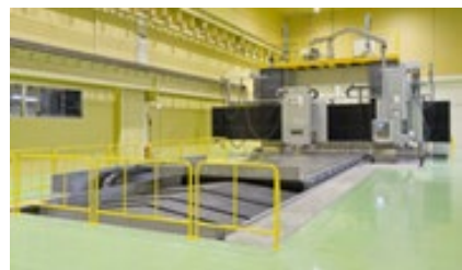
【超精密門形平面研削盤】 UDG10035NC [社内設備]
